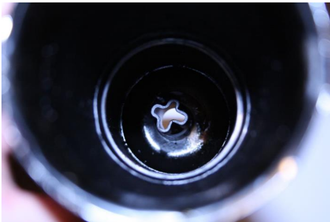
(Abb: Regelkomforme Endtüte mit Engstelle und Endrohr )
