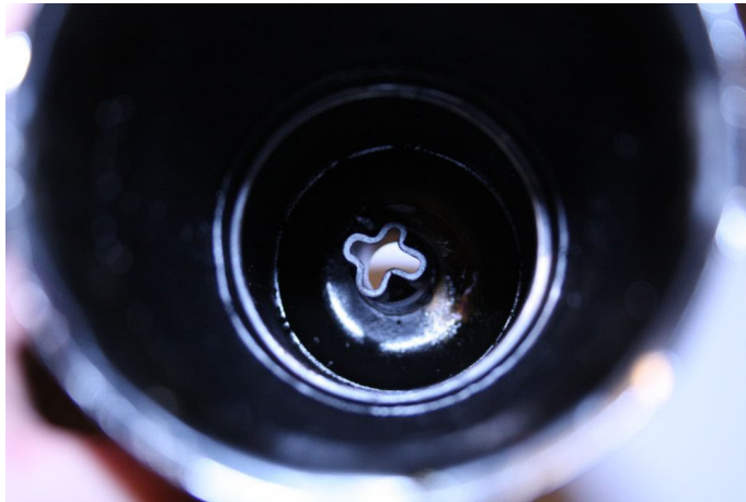
(Abb: Regelkomforme Endtüte mit Engstelle und Endrohr)
