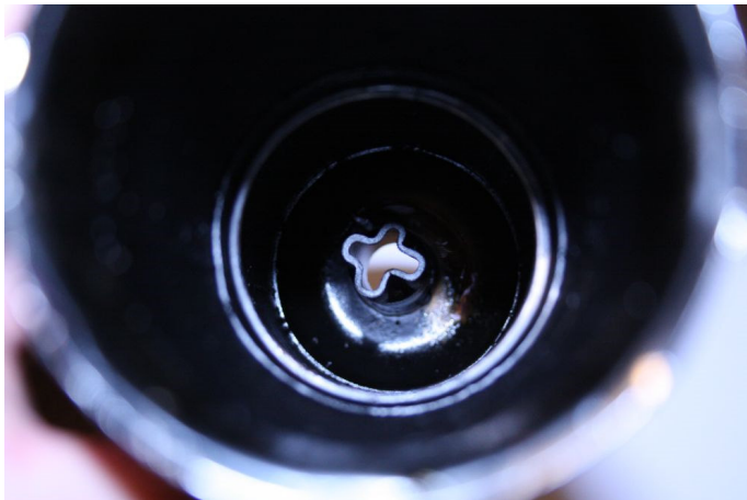
(Abb: Regelkomforme Endtüte mit Engstelle und Endrohr)
