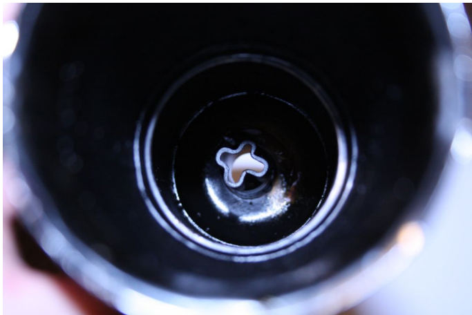
(Abb: Regelkomforme Endtüte mit Engstelle und Endrohr)
