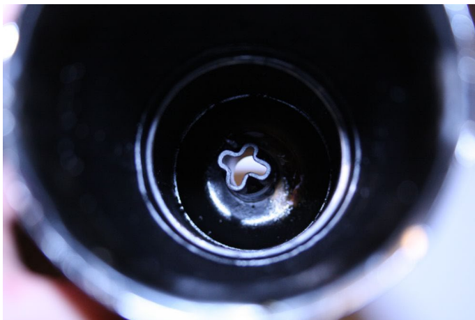
(Abb: Regelkomforme Endtüte mit Engstelle und Endrohr)
