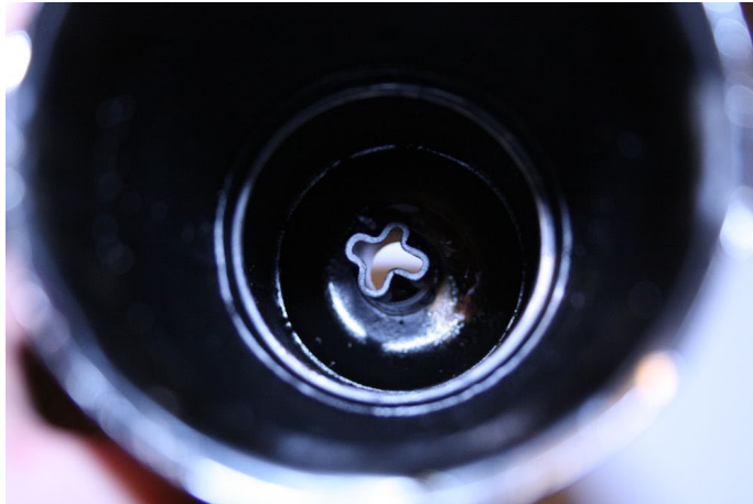
(Abb: Regelkomforme Endtüte mit Engstelle und Endrohr)
